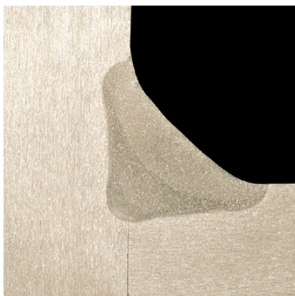
spoina pachwinowa wykonana metodą MIG z użyciem gazu Alulinx® (blacha 10 mm, stop Al 4140)
