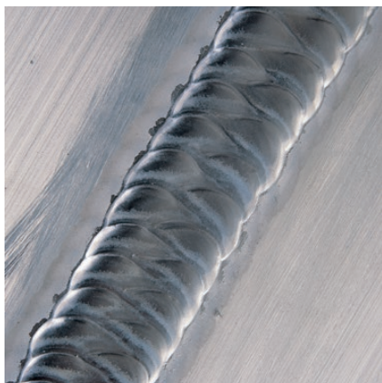
spoina czołowa wykonana metodą TIG z użyciem gazu Alulinx® (blacha 10 mm, stop Al 4140)
