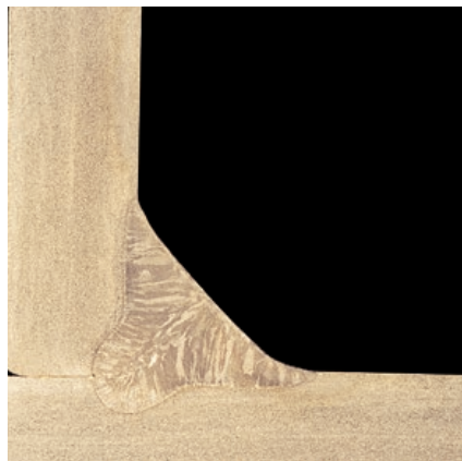
PB MAG (135) - spoina pachwinowa, austenityczna stal nierdzewna o grubości 6 mm, gaz osłonowy Inolinx® MAG.
